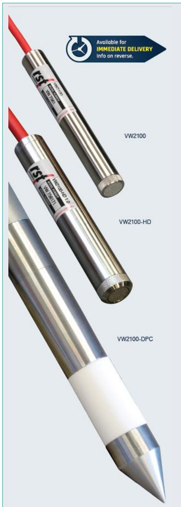
Струнный пьезометр, выпускаемый компанией RST, обеспечивает высокую точность, стабильность показаний и надежность в сложных геотехнических условиях. Струнные пьезометры являются наиболее эффективными электрическими пьезометрами, поскольку частотный выход струнных датчиков невосприимчив к внешним электрическим помехам и устойчив к влажной среде, обычной в геотехнических условиях применения.
