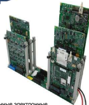
Модульные сменные электронные платы, заменяемые пользователем, обеспечивают удобное обслуживание и инновационность scai
