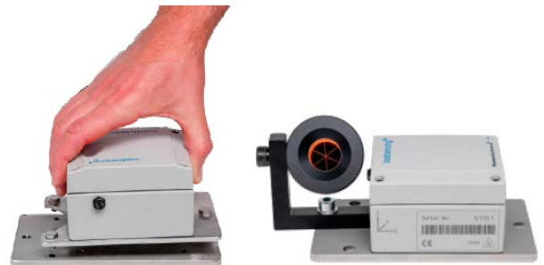
Рис. 6: Tilt90-i установлен на двойной пластине для горизонтального поверхностного монтажа (LS-ACC-IN15DP). Это подходит для тех случаев, когда необходимо избежать вскрытия корпуса при установке. На пластине имеется резьбовое отверстие для установки призмы мониторинга или винта с круглой головкой для точного выравнивания.
