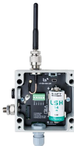
Рис. 1: Внутренний вид 1-канального регистратора данных для струнных датчиков Регистраторы данных представляют собой автономные устройства с батарейным питанием от аккумуляторов типоразмера C, которые могут работать несколько лет при минимальном
