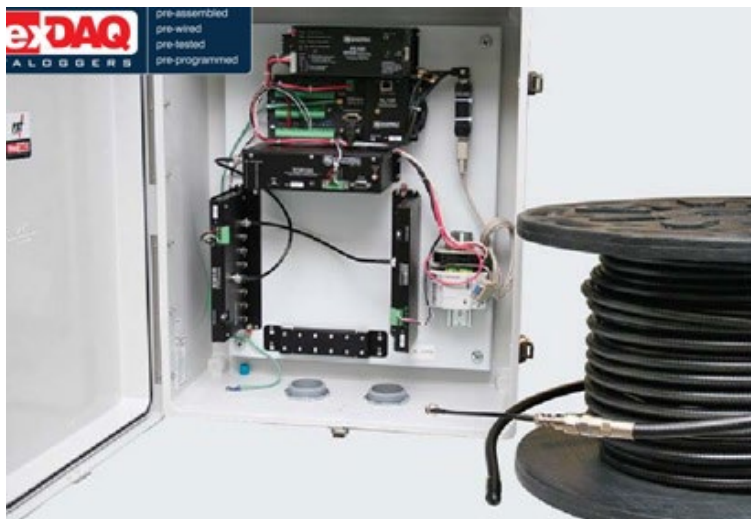
Регистратор данных FLEXDAQ с интерфейсом рефлектора, включая дополнительный TDR)
